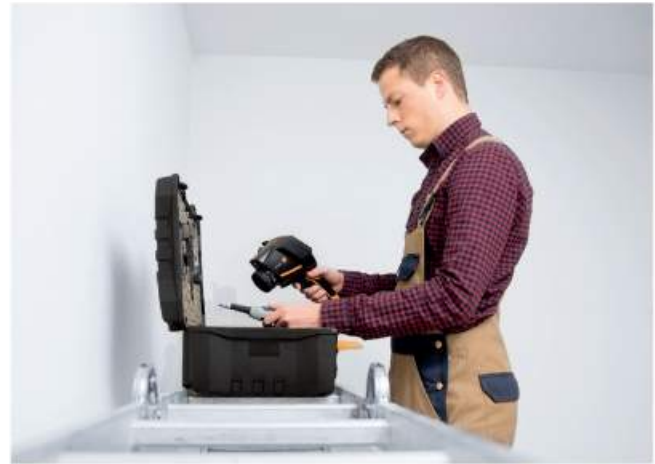
Dotazione del kit: termocamera con accessori, sonda igrometrica e valigetta.
